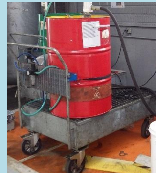
Figure 63. Exemple de fût sur rétention mobile
