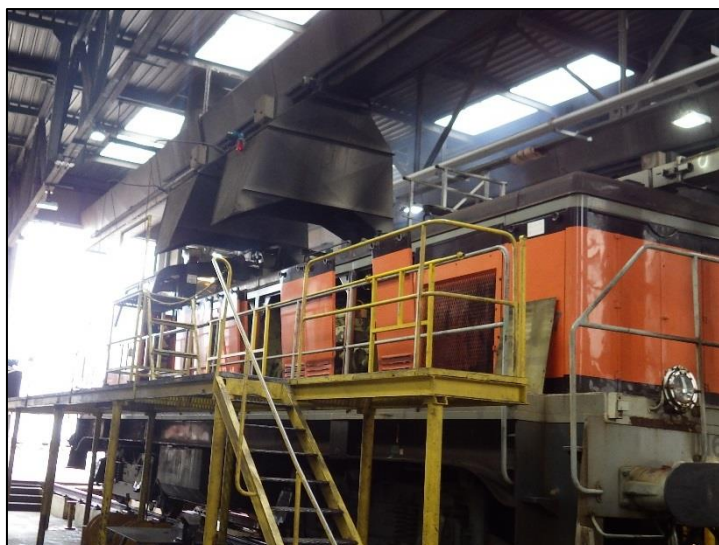
Figure 65. Essai moteur d'une locomotive sous hotte d'aspiration dans le bâtiment Rotonde (Cliché : Antea Group, 2016)
